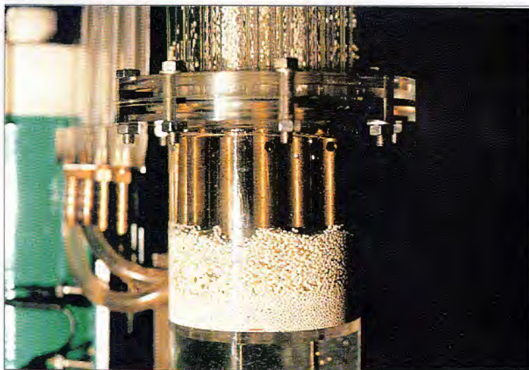
Feststoffpartikel in der Eintrittskammer des Wirbelschicht-Wärmeaustauschers / Твердые частицы во входной камере теплообменника вихревого типа
