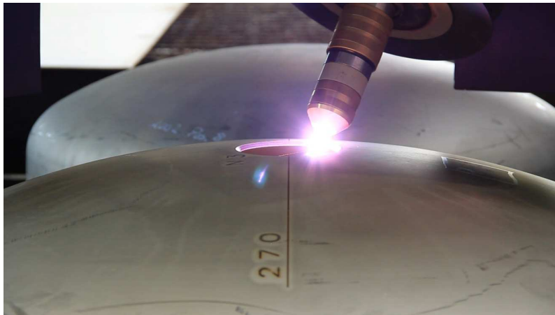
Beschneidung eines Klöpperbodens mit Fase.
