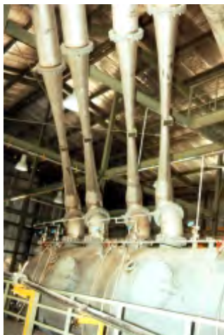
An einem Vakuumkühl- kristallisator installierte Dampfstrahlapparate Steam ejectors installed at a vacuum cooling crystallizer
