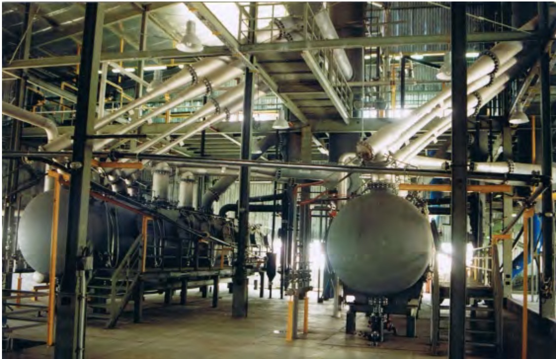
Zwei parallel geschaltete mehrstufige Vakuumkühlkristallisatoren zur Erzeugung von Glaubersalz Two parallel-connected multi-stage vacuum cooling crystallizers for the production of glauber's salt
