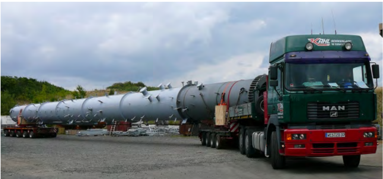
Die längste von EBNER gebaute Kolonne Länge: 41.000 mm The longest column built by EBNER Length: 41.000 mm
