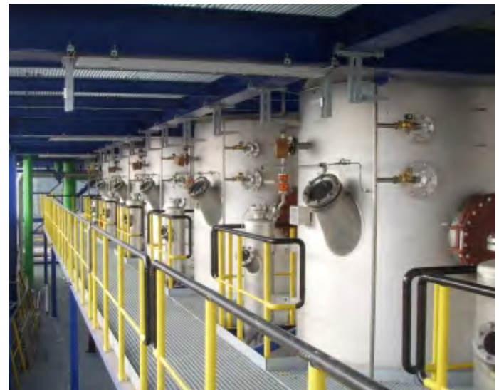
Verdampfungskristallisatoren mit Brüdenabzug in einer mehrstufigen Anlage Evaporation crystallizers with vapour exhaust in a multi-stage plant
