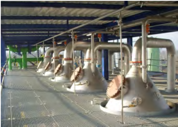
Verdampfungskristallisatoren mit Brüdenabzug in einer mehrstufigen Anlage Evaporation crystallizers with vapour exhaust in a multi-stage plant
