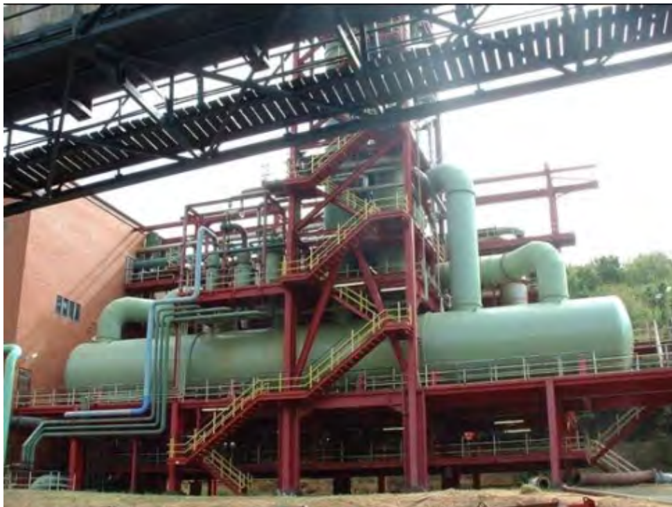
Vakuümkuhlkristallisationsanlage zur Erzeugung von \text{MgSO}_4 \cdot x 7\text{H}_2\text{O} Vacuum cooling crystallization plant for the production of \text{MgSO}_4 \cdot x 7\text{H}_2\text{O}
