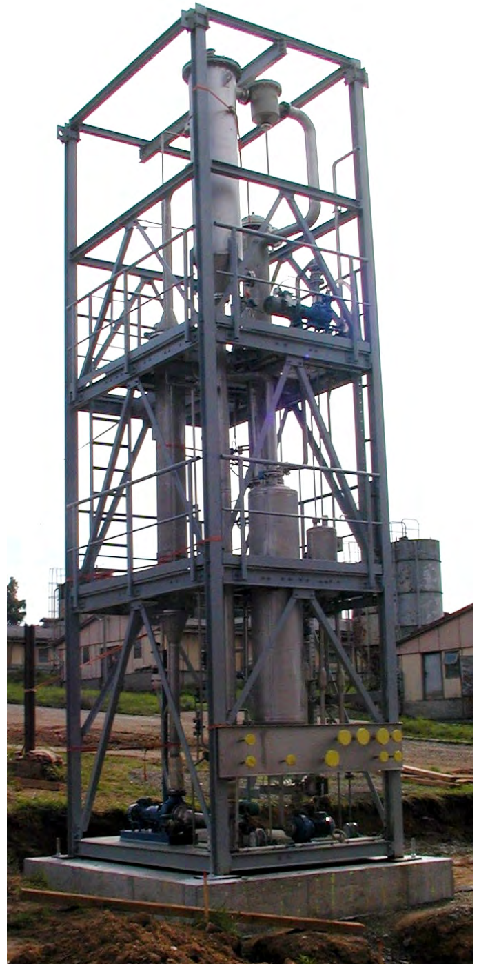
Pilotanlage zur Eindampfung von Schweinegülle Pilot plant for evaporation of pig slurry
