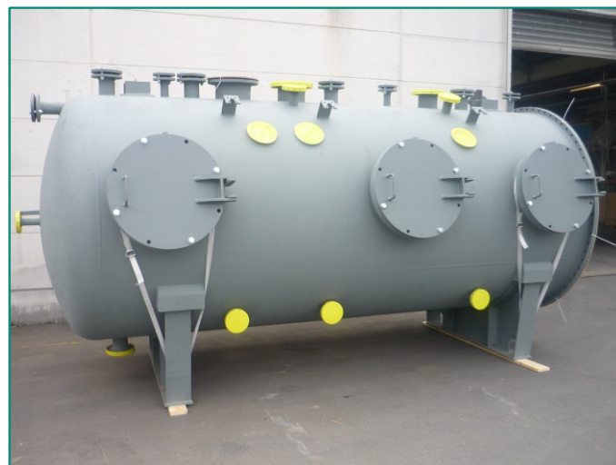
Kristallisatorteil fertig zum Versand материал: сталь / гуммированная
