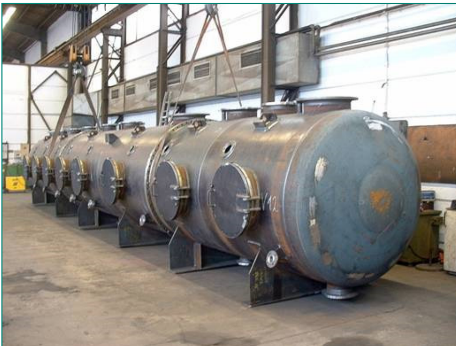
Расширительный испаритель материал: сталь / гуммированная
