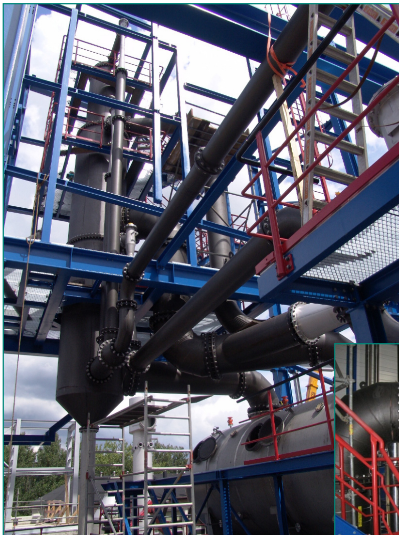
Смешивающие конденсаторы смонтированные в кристаллизационной установке
