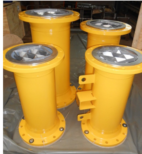
SMXL-High pressure mixer Ø 250 mm 1.4404 ASME mit U-Stamp
