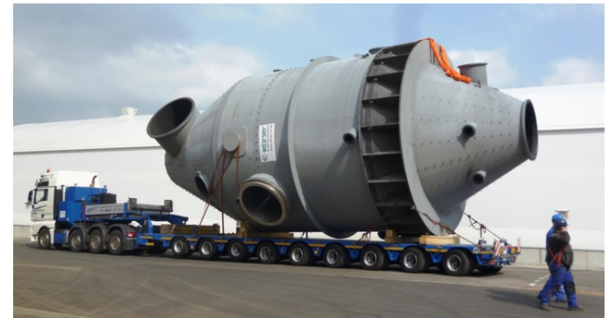
Evaporator Ø 6.000 mm, overall length 15.000 mm, 55 t
