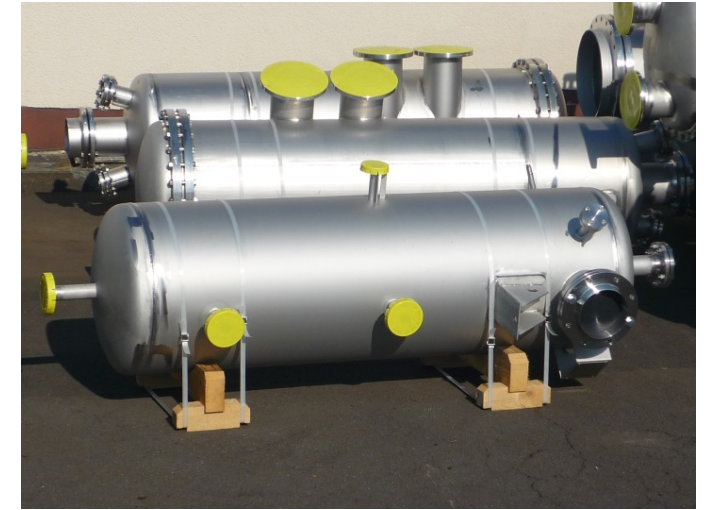
Separator Ø 700 mm, 1.4462
