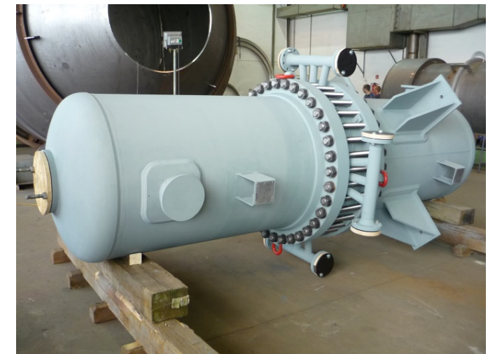
SMR Reaktor Ø 1.000 mm, SA 516 GR.60
