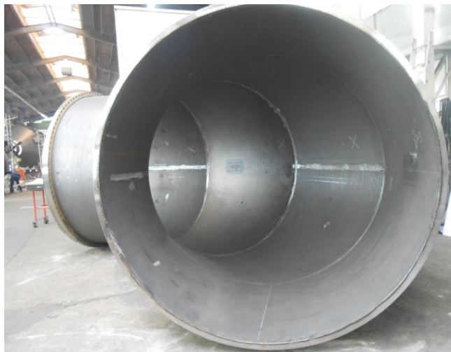
Vapour pipeline Ø 2.600 mm
