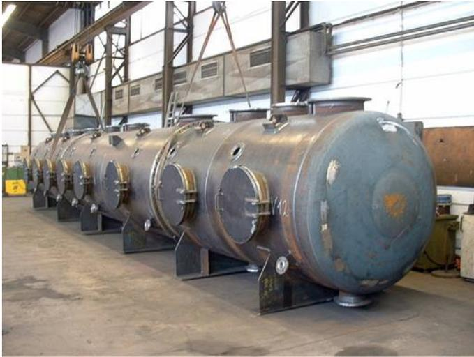
**Entspannungsverdampfer** Ø 3.500 mm, Stahl/gummiert
