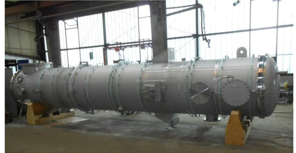
**Abgas-Kondensator** Ø 1.800 mm, 1.4541
