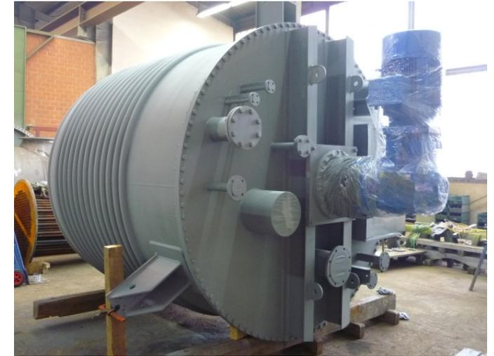
**Fertigung und Montage von Rührwerksbehältern inklusive EMSR-Technik (Deutschland)**
