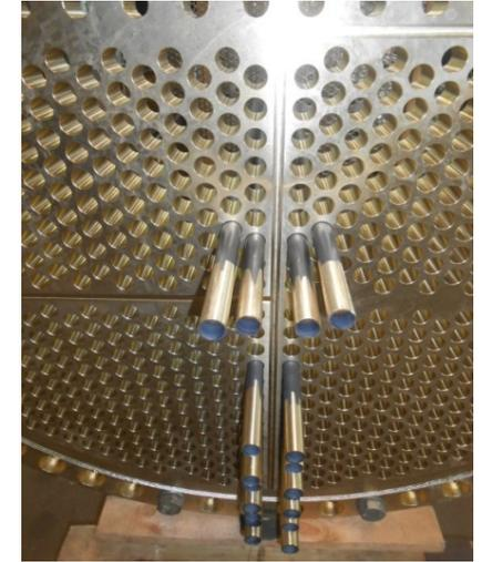
**Fertigung von Vorwärmern** für eine Eindampfkristallisation
