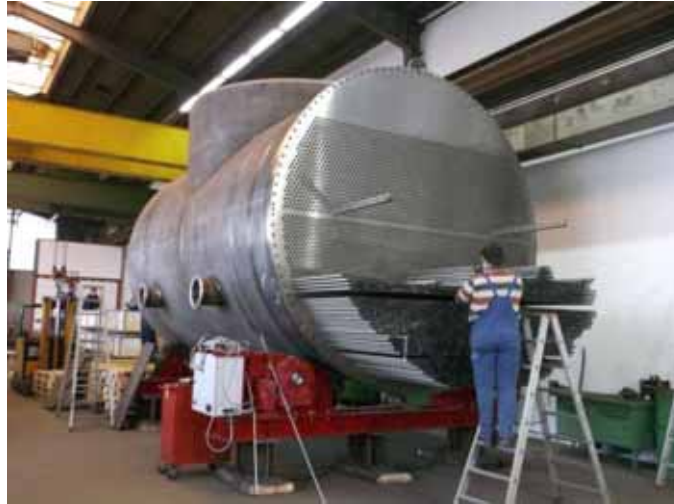
Fertigung und Montage (Niederlande) Seewasserkondensator Ø 3.650 mm, Gesamtlänge 10.000 mm, 40 t, 1.4462/P355GH
