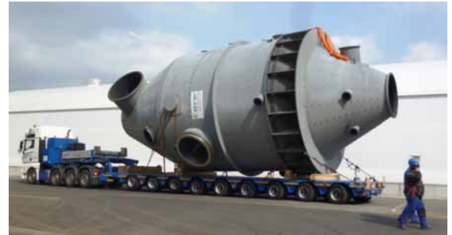
Verdampfer Ø 6.000 mm, Gesamtlänge 15.000 mm, 55 t
