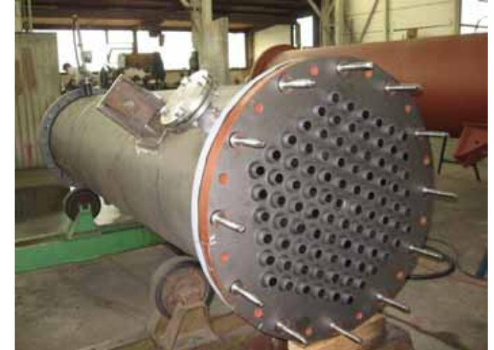
Wärmeaustauscher in verschiedenen Materialien wie z.B. Monel, Titan, Alu-Bronze, Graphit
