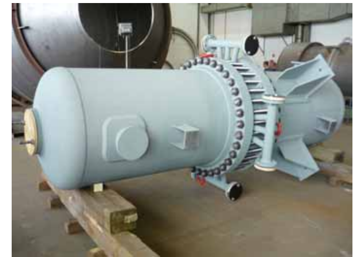
SMR Reaktor Ø 1.000 mm, SA 516 GR.60
