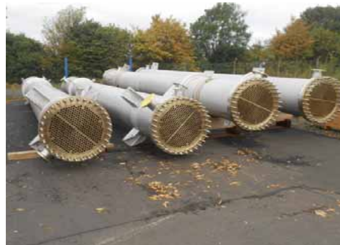
Fertigung von Vorwärmern für eine Eindampfkristallisation Ø 800 mm - Ø 1.300 mm, Gesamtlänge 11.700 mm, Gewicht 8,8 - 21,8 t, Alubronze
