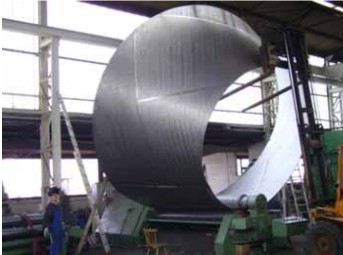
Baustellenfertigung und Montage (Österreich) Verdampfungskristallisator Ø 6.400 mm, Gesamtlänge 18.700 mm, 56 t, 1.4562
