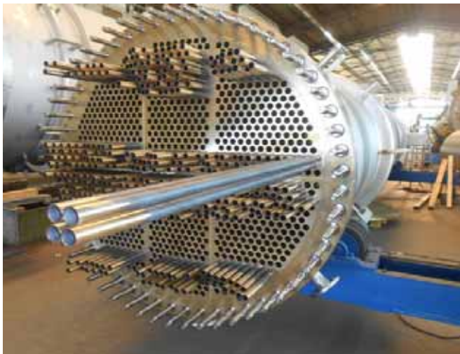
Fertigung von Vorwärmern für eine Eindampfkristallisation Ø 800 mm - Ø 1.300 mm, Gesamtlänge 11.700 mm, Gewicht 8,8 - 21,8 t, Alubronze
