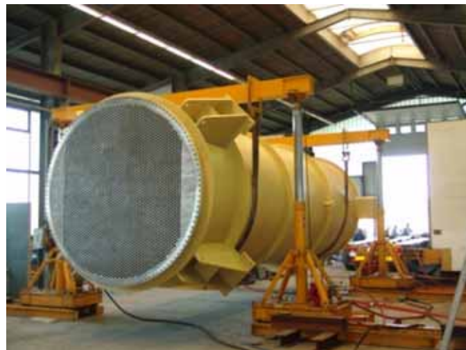
Wärmeaustauscher in verschiedenen Materialien wie z.B. Monel, Titan, Alu-Bronze, Graphit
