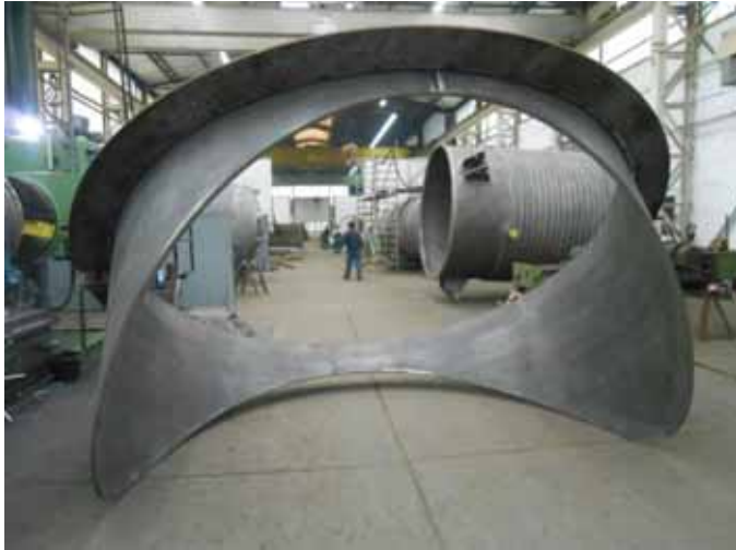
Fertigung und Montage (Niederlande) Seewasserkondensator Ø 3.650 mm, Gesamtlänge 10.000 mm, 40 t, 1.4462/P355GH
