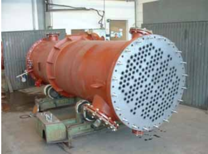
Wärmeaustauscher in verschiedenen Materialien wie z.B. Monel, Titan, Alu-Bronze, Graphit
