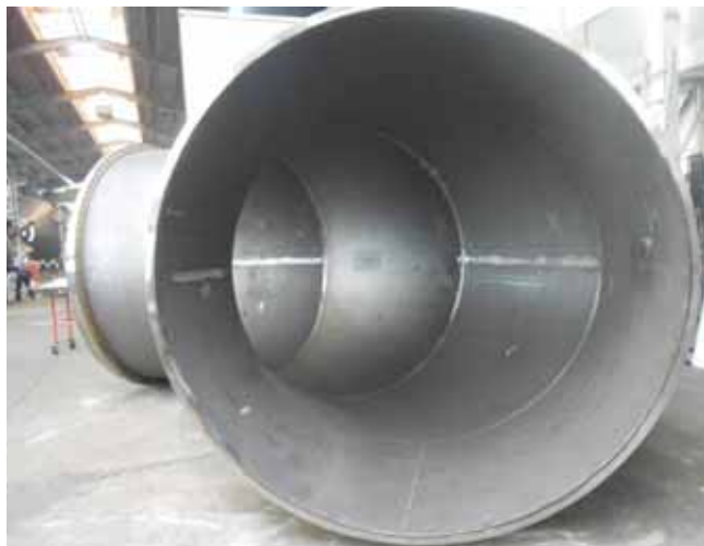
Brüdenrohrleitung Ø 2.600 mm
