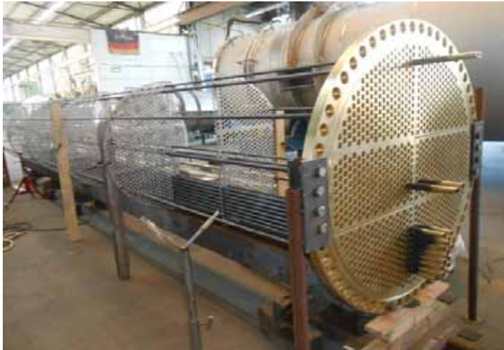
Fertigung von Vorwärmern für eine Eindampfkristallisation Ø 800 mm - Ø 1.300 mm, Gesamtlänge 11.700 mm, Gewicht 8,8 - 21,8 t, Alubronze
