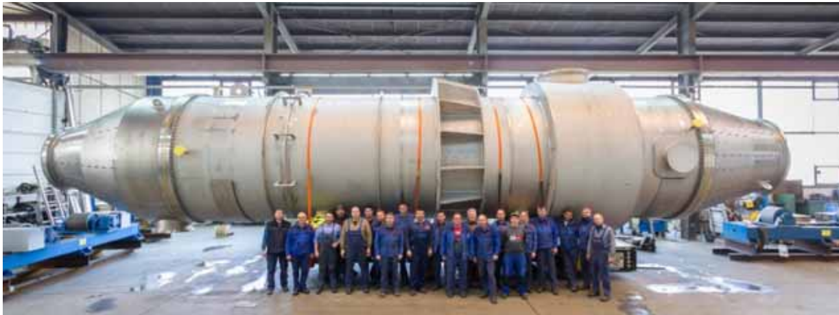
Wärmeaustauscher Ø 3.150 mm, Rohrlänge 9.000 mm, 113 t
