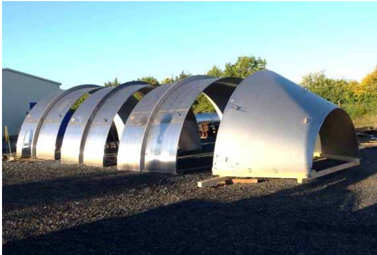
Baustellenfertigung und Montage (Russland) Verdampfungskristallisator Ø 5.400 mm, Gesamtlänge 21.800 mm, 40 t, 1.4562
