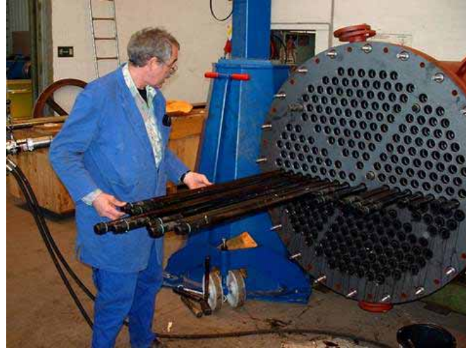
Wärmeaustauscher in verschiedenen Materialien wie z.B. Monel, Titan, Alu-Bronze, Graphit
