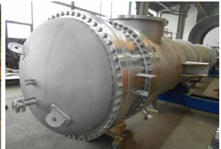
Fertigung von Vorwärmern für eine Eindampfkristallisation Ø 800 mm - Ø 1.300 mm, Gesamtlänge 11.700 mm, Gewicht 8,8 - 21,8 t, Alubronze
