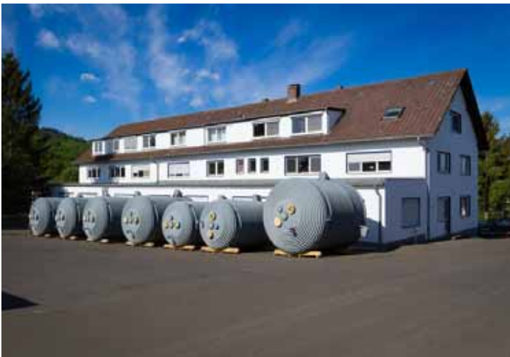
Fertigung und Montage von Rührwerksbehältern inklusive EMSR-Technik (Deutschland) Ø 2.200 mm - Ø 3.000 mm, Gesamthöhe 5.700 mm, Gewichte 7 - 11,6 t, Stahl
