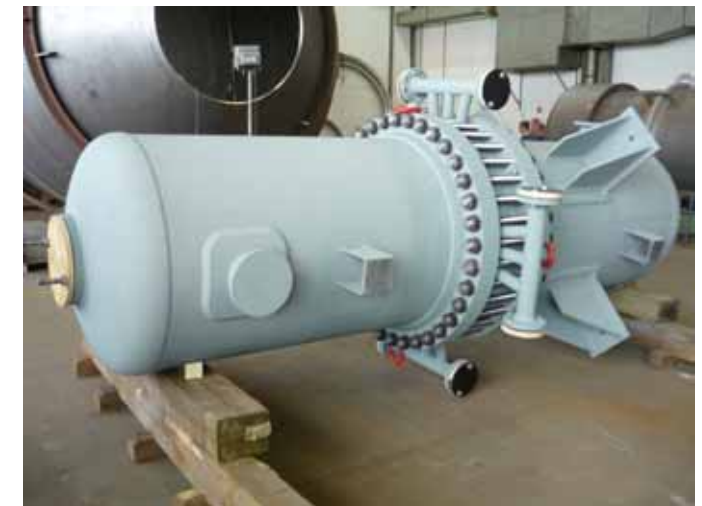
SMR Reaktor Ø 1.000 mm, SA 516 GR.60
