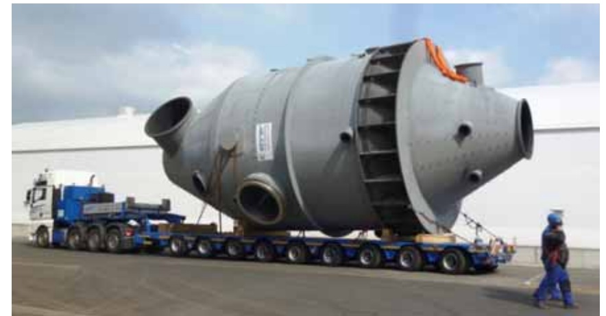
Evaporator Ø 6.000 mm, overall length 15.000 mm, 55 t
