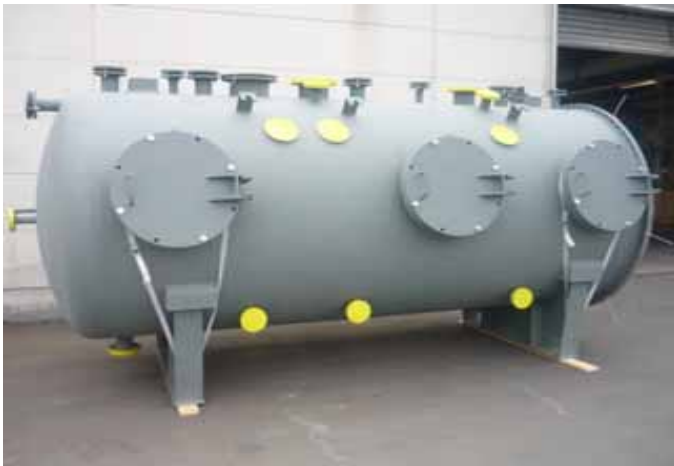
Часть кристаллизатора Ø 1.800 мм, сталь/гумированная 516 GR.60
