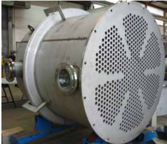
Конденсатор олеума Ø 1.650 мм, 1.4571
