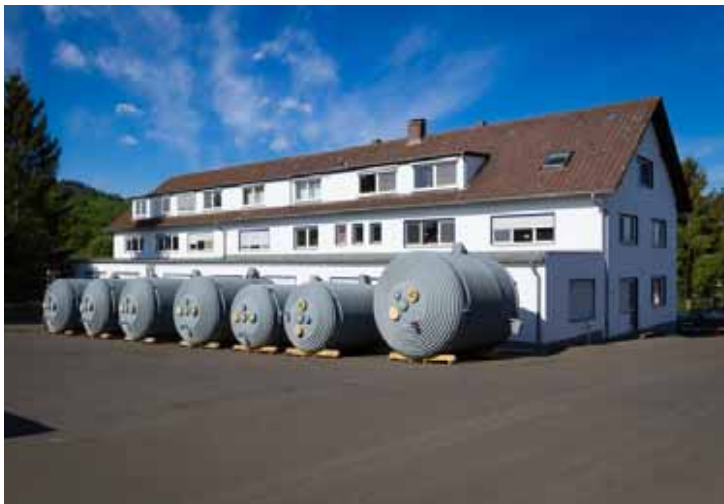
Изготовление и монтаж емкостей с мешалкой вкл. КИП (Германия) Ø 2.200 мм - Ø 3.000 мм, общая высота 5.700 мм, вес 7 - 11,6 т, сталь
