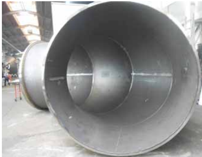
Трубопровод вторичного пара Ø 2.600 мм
