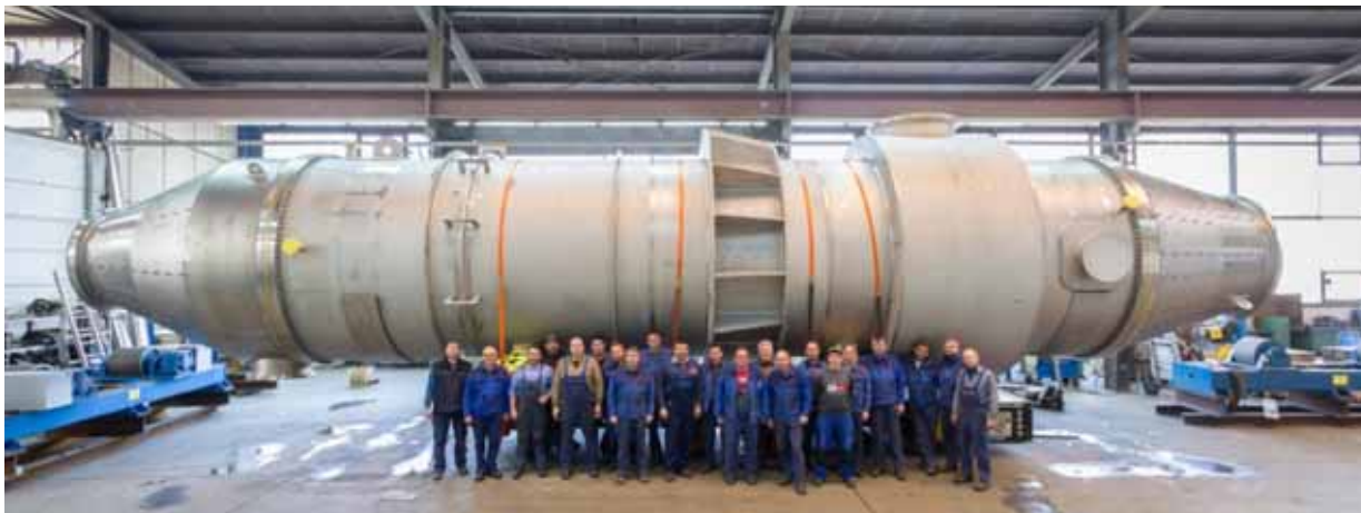
Теплообменник Ø 3.150 мм, длина труб 9.000 мм, 113 т
