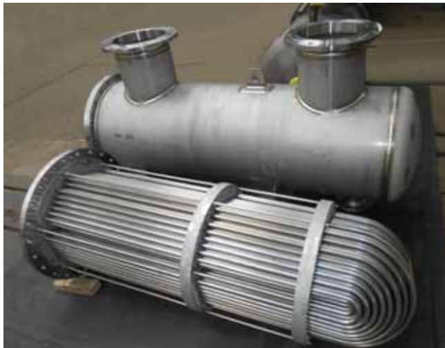
Конденсатор с выдвижным пучком Ø 610 мм, 1.4571
