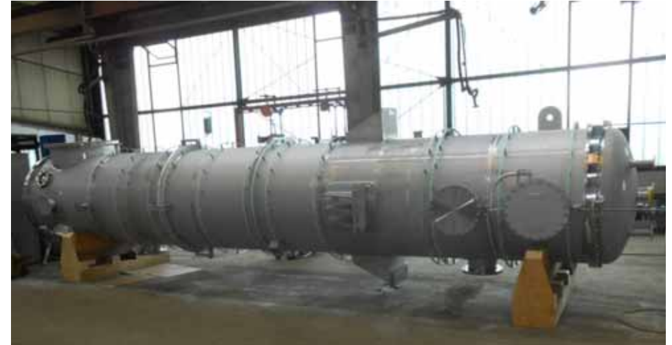
Конденсатор газообразных отходов Ø 1.800 мм, 1.4541
