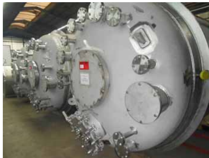
Аппарат с мешалкой Ø 2.400 мм, 1.4571
