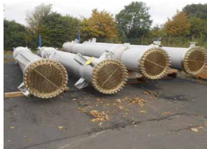
Производство подогревателей для испарительной кристаллизации Ø 800 мм - Ø 1.300 мм, общая длина 11.700 мм, вес 8,8 - 21,8 t, алюминиевая бронза
