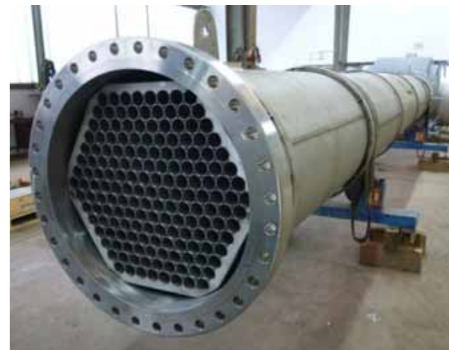
Направитель потока Ø 950 мм, 1.4404
