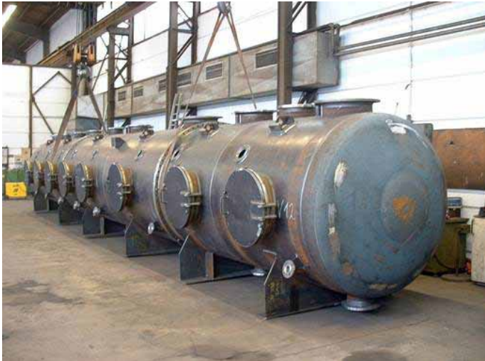
Редукционный выпарной аппарат Ø 3.500 мм, сталь/гумированная
