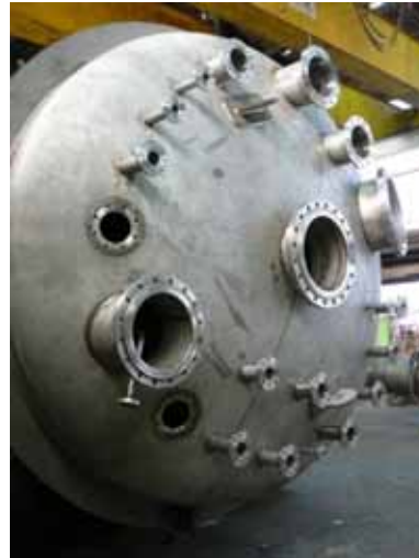
Реактор Ø 3.500 мм, 1.4539
