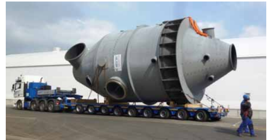
Испаритель Ø 6.000 мм, общая длина 15.000 мм, 55 т
