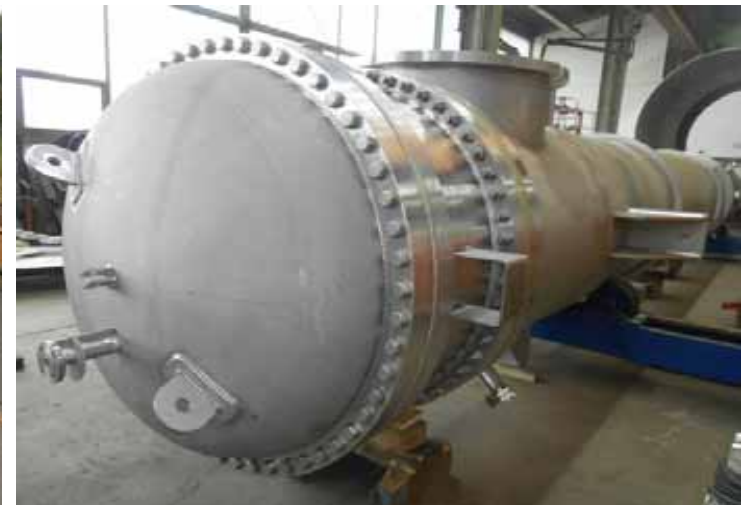
Производство подогревателей для испарительной кристаллизации Ø 800 мм - Ø 1.300 мм, общая длина 11.700 мм, вес 8,8 - 21,8 t, алюминиевая бронза
