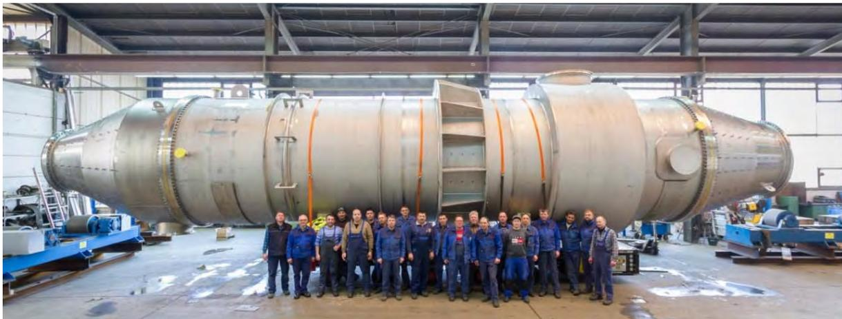
**Wärmeaustauscher** Ø 3.150 mm, Rohrlänge 9.000 mm, 113 t
