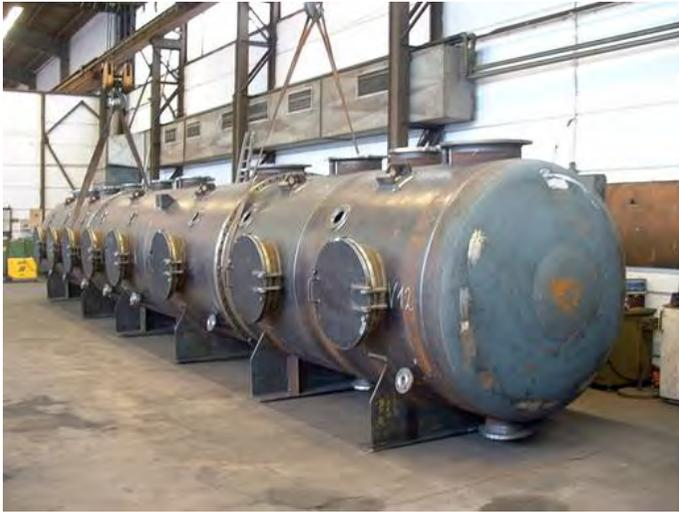
**Entspannungsverdampfer** Ø 3.500 mm, Stahl/gummiert
