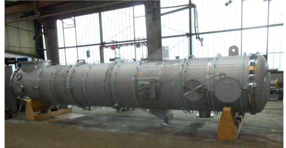
**Abgas-Kondensator** Ø 1.800 mm, 1.4541
