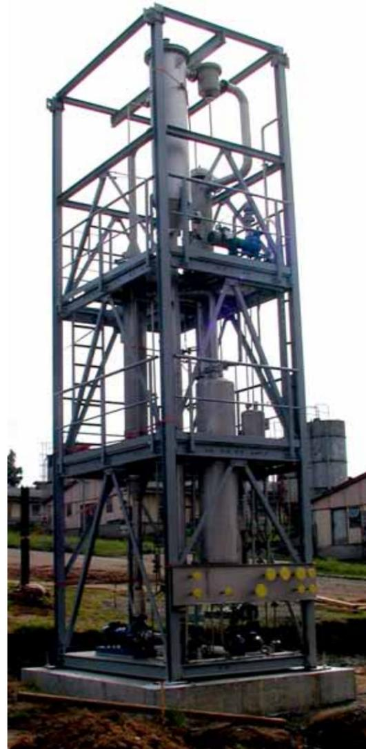
Pilotanlage zur Eindampfung von Schweinegülle
