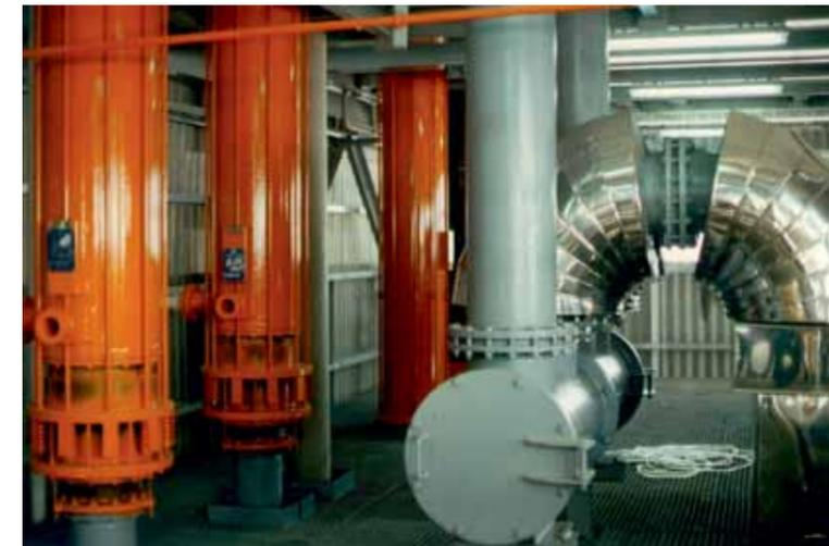
Absorptionsanlage für HCl / Absorption plant for HCl
