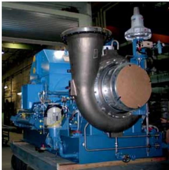
Mechanischer Brüdenverdichter (Turbokompressor)
