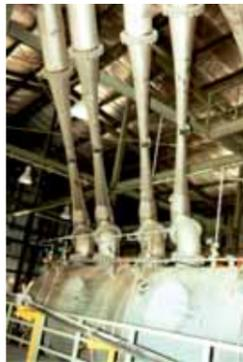
An einem Vakuumkühlkristallisator installierte Dampfstrahlapparate
