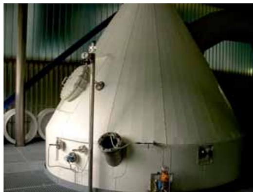
Verschiedene Ansichten von einer Mutterlaugenaufbereitung zur Produktion von NaCl und  $K_2SO_4$
