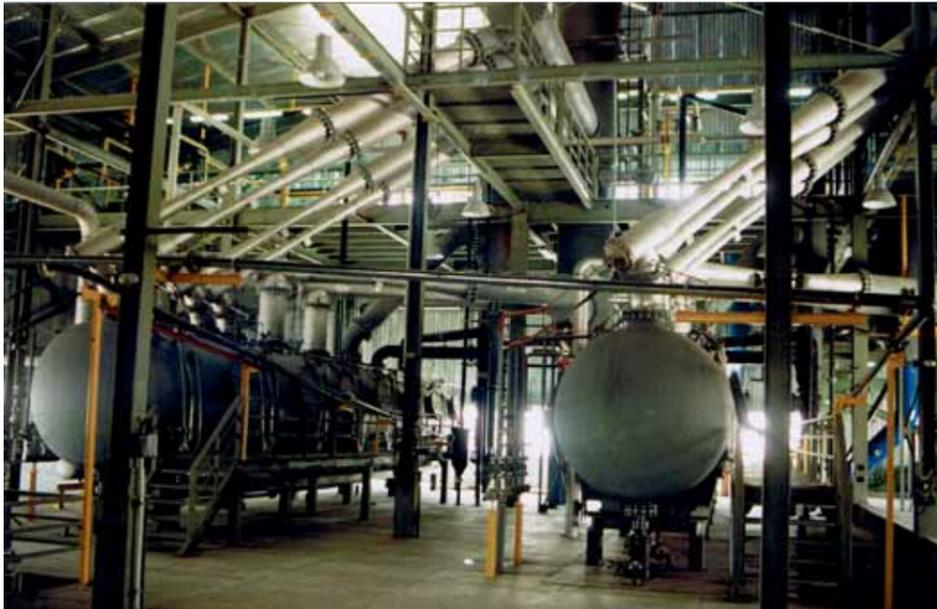
Zwei parallel geschaltete mehrstufige Vakuumkühlkristallisatoren zur Erzeugung von Glaubersalz
