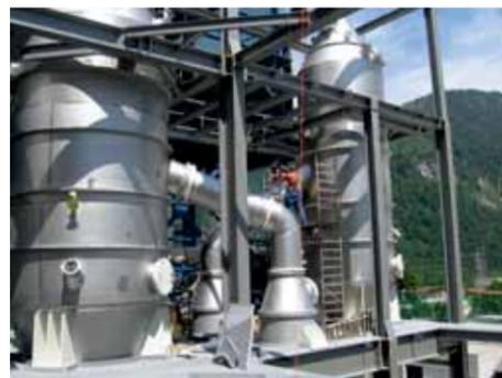
Schmelzkristallisator, ausgeführt als Verdampfungskristallisator
